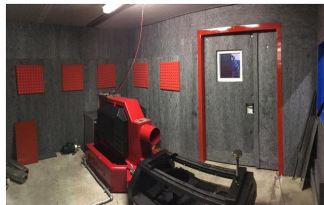
Fig. 4 - rivestimento pareti sala prova motori
